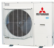
Buitenunit FDC100VSA-W/1 10,0 kW 380/415V-3-50Hz warmtepomp inverter R32
